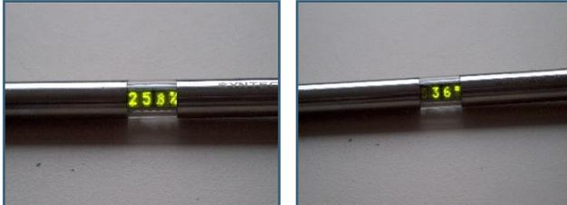
The display goes out, a Countdown "----, ---, --, -" shows the progress of the measurement.
